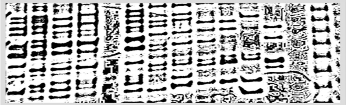
Figura 3.7: Resultado de teste em algoritmo no FEPI, limiarização local adaptativa de Niblack
