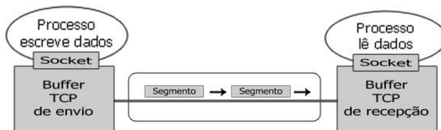
Figura 2.2: Processo de Envio de Dados utilizando TCP
