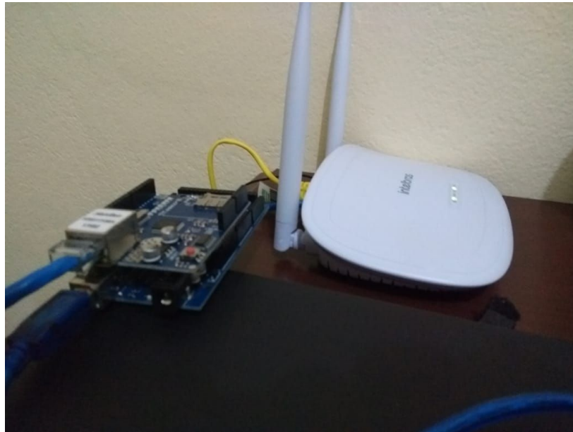
Figura 17 - Arduino conectado a um roteador através do Ethernet Shield W5100 . Fonte: Do Autor.
