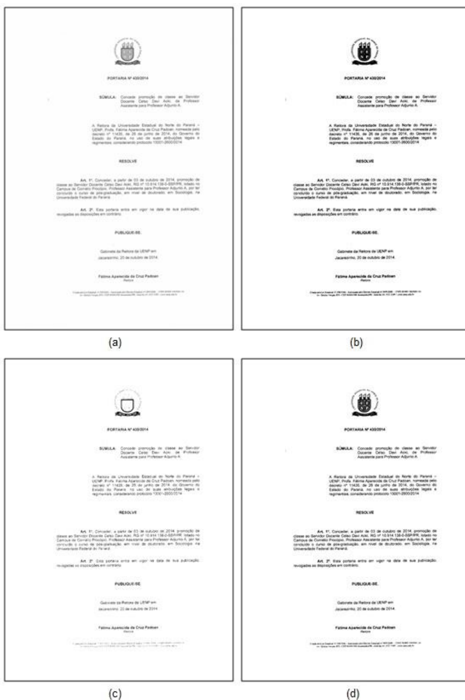
Figura 14: Teste entre algoritmos de binarização, (a) imagem em escala de cinza, (b) imagem binarizada por Johannsen, (c) imagem binarizada por Threshold T = 128 , (d) imagem binarizada por OTSU.
