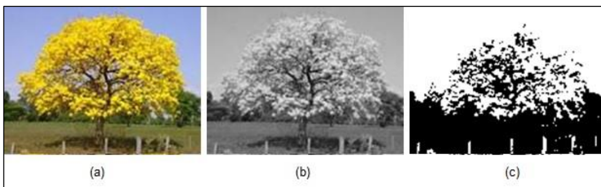
Figura 4: (a) imagem original, (b) imagem em tons de cinza e (c) imagem binária.
