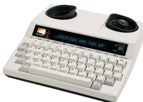
Figura 5 – Exemplo de um telefone de texto (TTY). Imagem retirada do site "Notisurdo".
