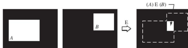
Figura 12 – Operação AND entre duas imagens, adaptado de [3]
