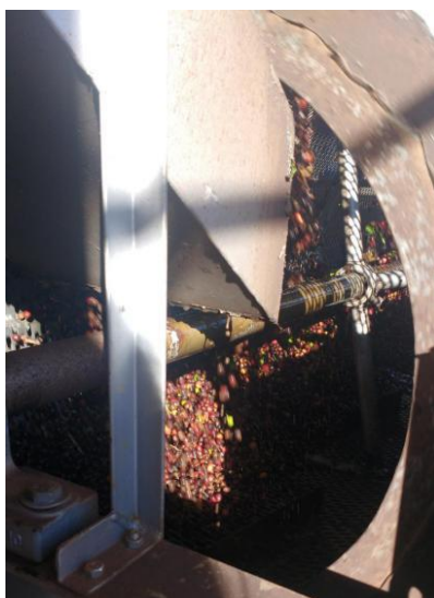
Figura 13: Roda para escorrer a água (Parte da Via Úmida)
