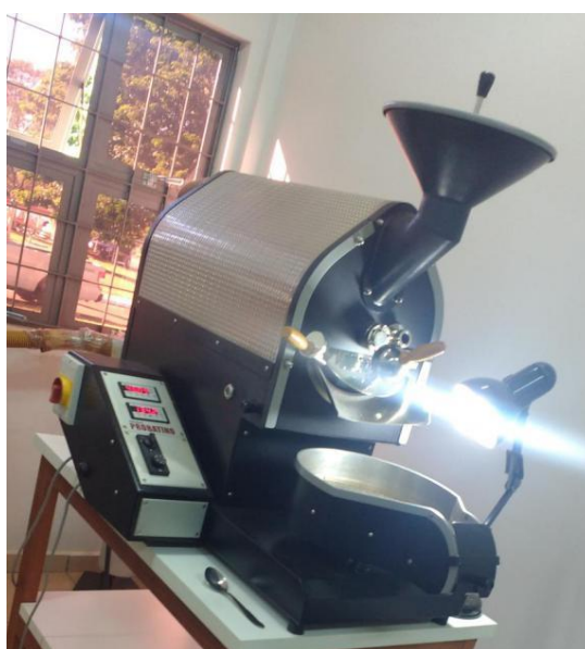
Figura 25: Torrador de café elétrico
