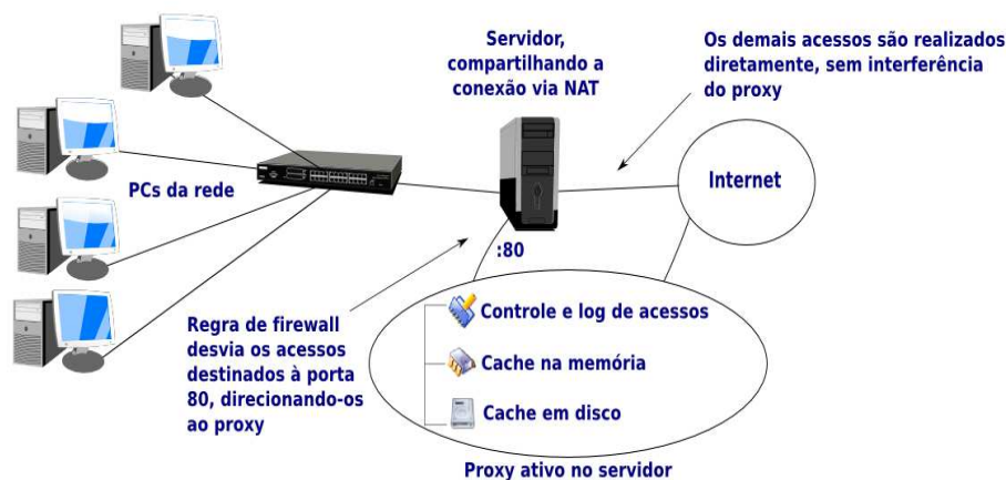
Figura 2 - Funcionamento de um Servidor Proxy. WESSELS (2004)
